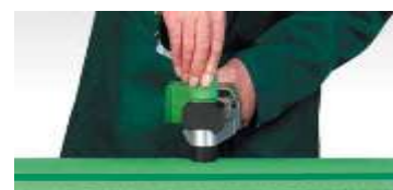
CHAUFFAGE DES ELEMENTS A SOUDER
