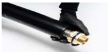
DENUDER LES 6 PREMIERES ONDES INSERER LE RACCORD JUSQU'AU "CLIC"
