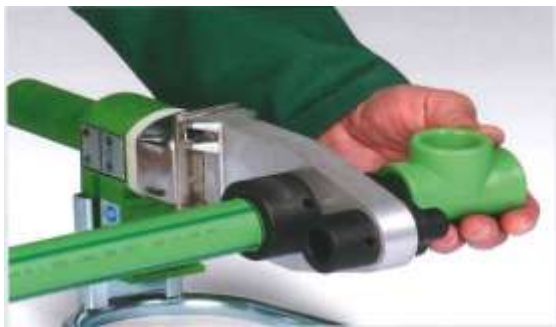
CHAUFFE DES ELEMENTS
